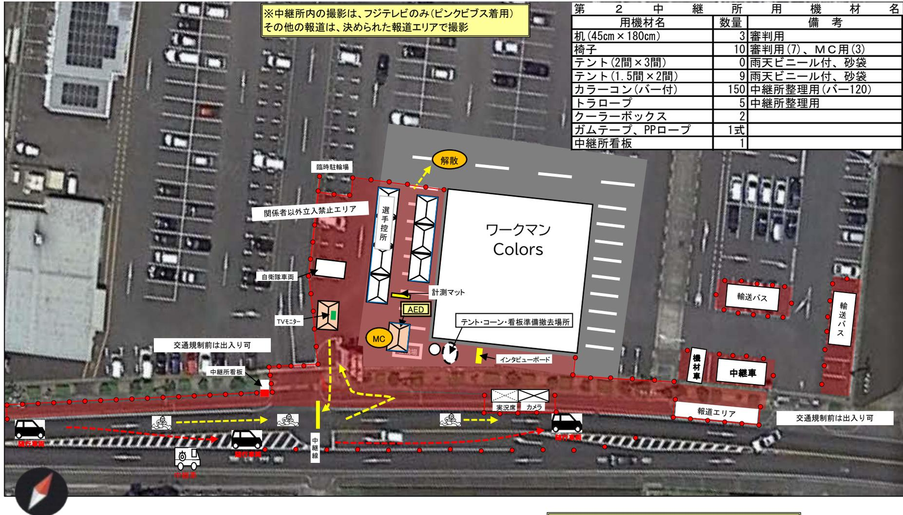
交通規制開始時に5m間隔でコーンを設置する。
